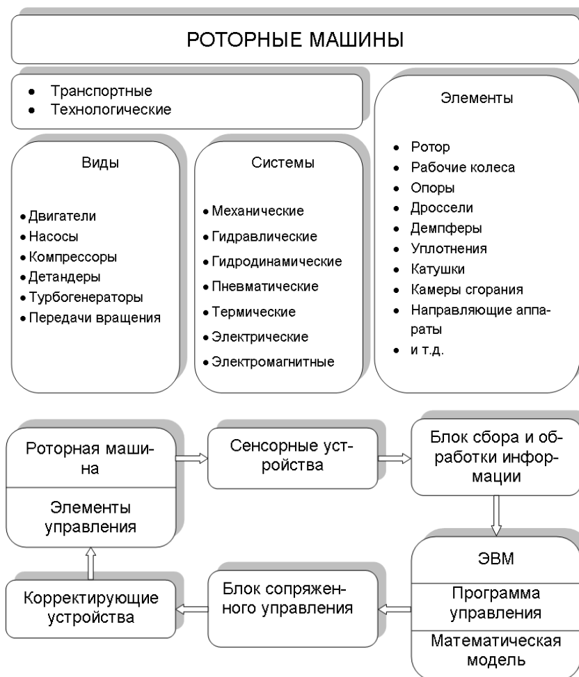
Рис.1 Элементы и принципиальная схема активного управления в роторных машинах
