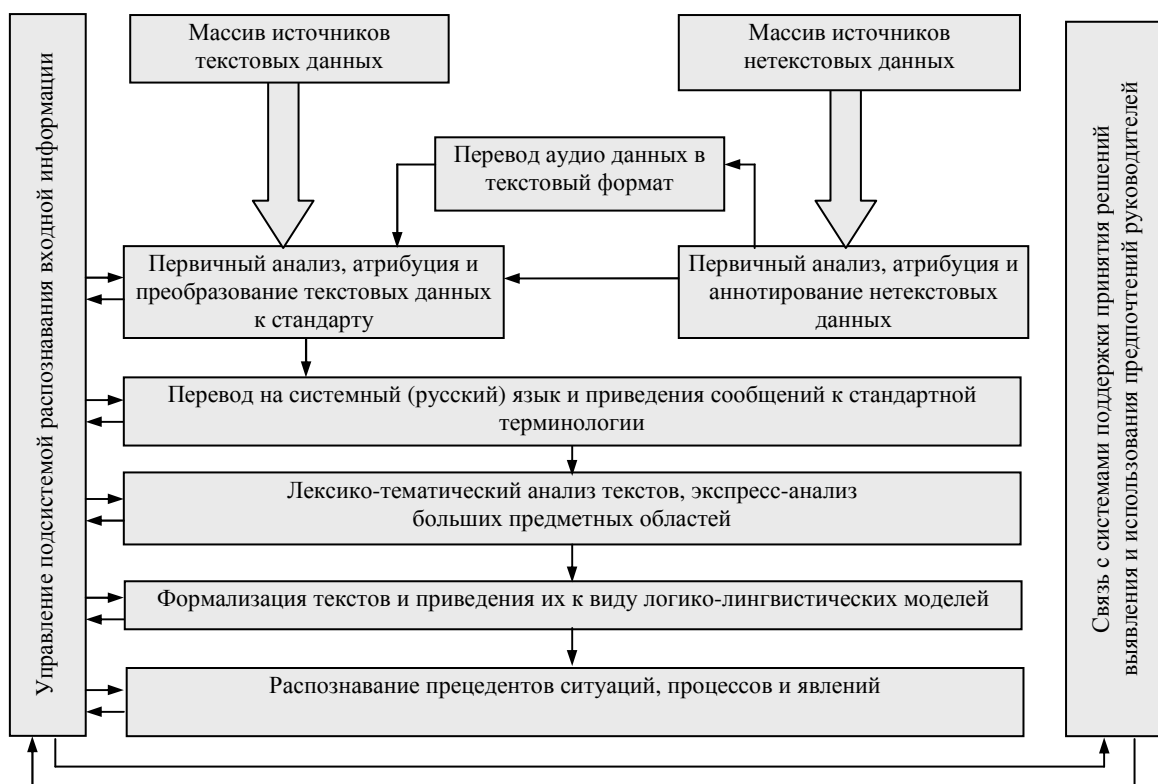
Рис. 2. Схема анализа текстовой информации
