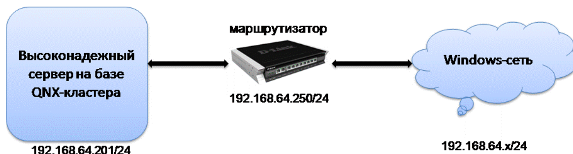
Рис. 1. Архитектура сети с кластером.
